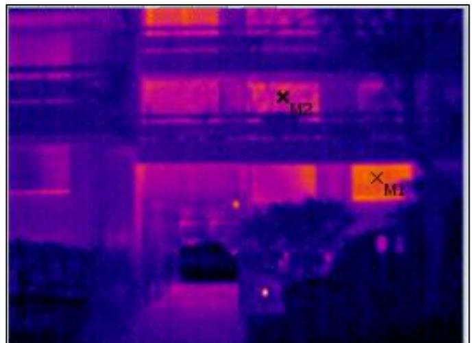
Le type de menuiseries a également un impact important sur la quantité de déperditions. En effet les menuiseries d'origines sont plus déperditives que les menuiseries plus récentes ayant une performance thermique plus élevée. Le profil des températures sur la droite verticale P1 tracée ci-dessous le montre. Plus la température est élevée, plus les déperditions sont importantes. Le graphique ci-dessous se lit pour la droite du haut vers le bas, de gauche à droite pour le graphique :
