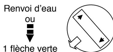
Régalez manuellement la roue de programmation en position " **Remplissage d'eau du bac à sel**", ou " ▼ " (flèche verte) et laissez le bac à saumure se remplir jusqu'à l'arrêt.
