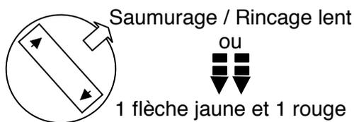
Réglez manuellement la roue de programmation en position " **Saumurage/Rinçage lent** " (aspiration de saumure), ou " ↓↓ " (flèche jaune et rouge) et laissez l'eau monter jusqu'à la vanne.
