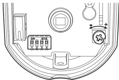
> Interrupteur 1 : s'il est en bas, désactive la led en façade lors d'une transmission radio pour plus de discrétion
