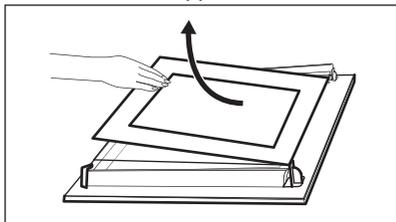
8. Nettoyez les panneaux vitrés avec de l'eau et du savon. Séchez les panneaux vitrés soigneusement.
