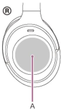
A : panneau de commande du capteur tactile
