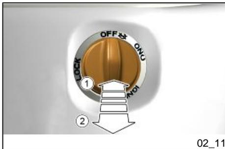
Une fois le contacteur de démarrage activé (voir paragraphe « Télécommande », appuyer dessus et, conformément aux indications figurant sur l'écran digital, le tourner dans la position «**ON**» ; un message de « Bienvenue » sera affiché.
