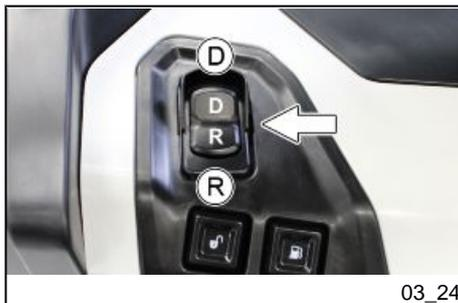
Une fois la manœuvre terminée, mettre le sélecteur Drive/Marché arrière sur «**D**» pour rétablir le mode normal de marche avant ; la caméra de recul s'éteindra.
