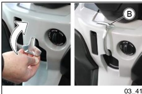
Pour serrer le frein de stationnement, il faut soulever le levier en le portant de la position « A » à la position « B ».
