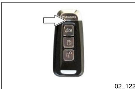
Par la suite, pour vérifier l'état du système « **Piaggio Keyless** », appuyer légèrement sur l'un des trois boutons de la télécommande.
