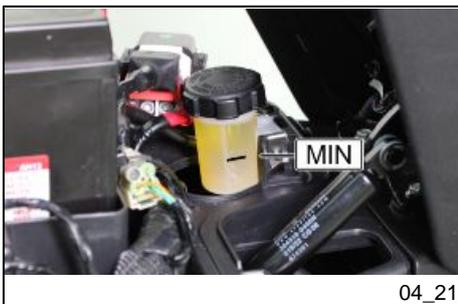
Si le niveau de liquide du système de freinage intégral est au-dessous du repère **MIN** indiqué sur le réservoir, ne pas utiliser le véhicule et contacter un **Point d'assistance agréé**.
