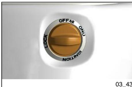
Quand le frein de stationnement est actionné sur « **B** » et le commutateur d'allumage est sur « **LOCK** », le système de sécurité s'active pour éviter la désactivation du frein.
