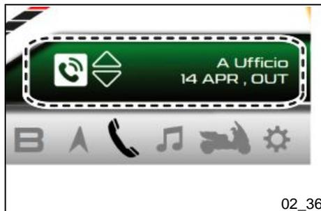
Le système **PMP-PIAGGIO MIA** dialogue avec l'utilisateur par le biais de messages pouvant être visualisés sur le panneau Pop-up de l'afficheur numérique. En fonction du type de message, le panneau graphique affiche l'icône, les couleurs et le message spécifique.
