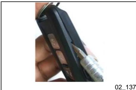
Retirer les boutons et dévisser les vis de fixation.
