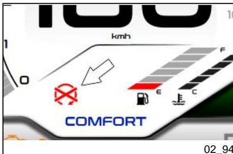
Si le démarrage est interdit, l'icône correspondante s'allumera également sur l'afficheur numérique.
