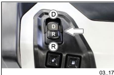
Avec le sélecteur de mode Drive/Marche arrière sur « D » (Drive), sélectionner le mode de conduite préétabli, en exerçant une pression courte sur le bouton de démarrage (se référer au paragraphe « **Affichage numérique** »).
