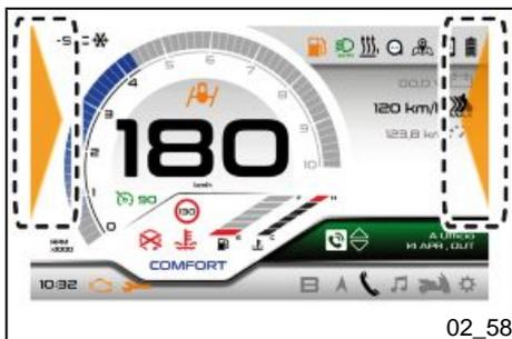
Avec le système L.C.D.A.S. activé, l'éventuel signal de danger à la suite d'un changement de direction, se présentera automatiquement comme une alarme visuelle sur l'écran numérique par le biais de triangles de couleur jaune.
