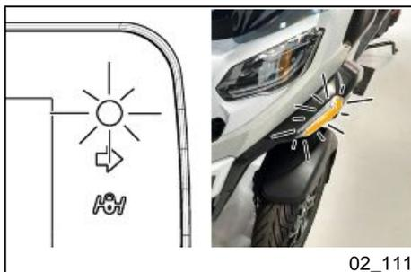
Par la suite, lors de l'arrêt du véhicule, en tournant le contacteur d'allumage sur « **OFF** », le voyant de l'ANTIDÉMARRAGE et les clignotants clignoteront simultanément pendant 20 secondes pour indiquer la perte de la télécommande.
