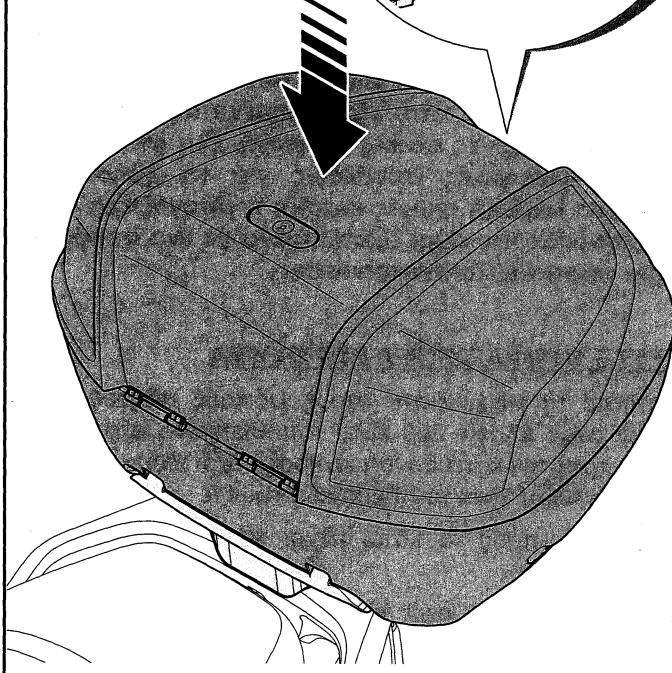
**i** Une fois la plaque d'interface installée sur le véhicule (opération à réaliser par un concessionnaire qualifié, voir les instructions de montage spécifiques fournies), aucune autre connexion électrique n'est nécessaire pour utiliser le top case keyless : le top case et la plaque d'interface sont équipés d'un système de recharge et de dialogue sans fil.
