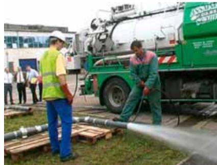
Test d'hydro-curage à haute pression : pression de curage de 150 bar à la pompe, soit 100 bar à la sortie de la buse (norme suisse SN 592 012).
