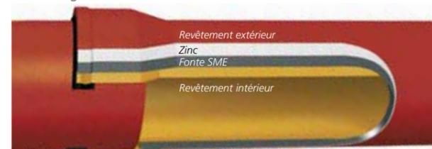
Les raccords sont revêtus intérieurement et extérieurement d'un film époxydique brun-rouge déposé par cataphorèse renforcée
